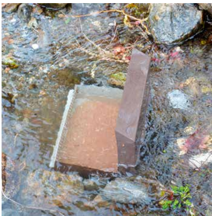
Cassetta metallica artigianale, ad ispirazione metodo Vibert, di capacità pari a 7000 uova embrionate. Foto scattata durante la fase di posa in ambiente
