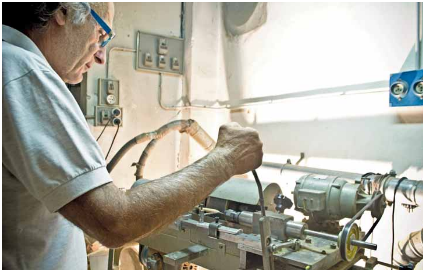
Mio padre all'opera. Il tappo viene tornito per dargli la forma.
