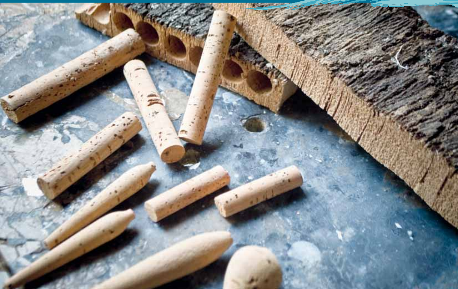
La prima fase della lavorazione: dalla corteccia del sughero si ricava un tappo cilindrico
