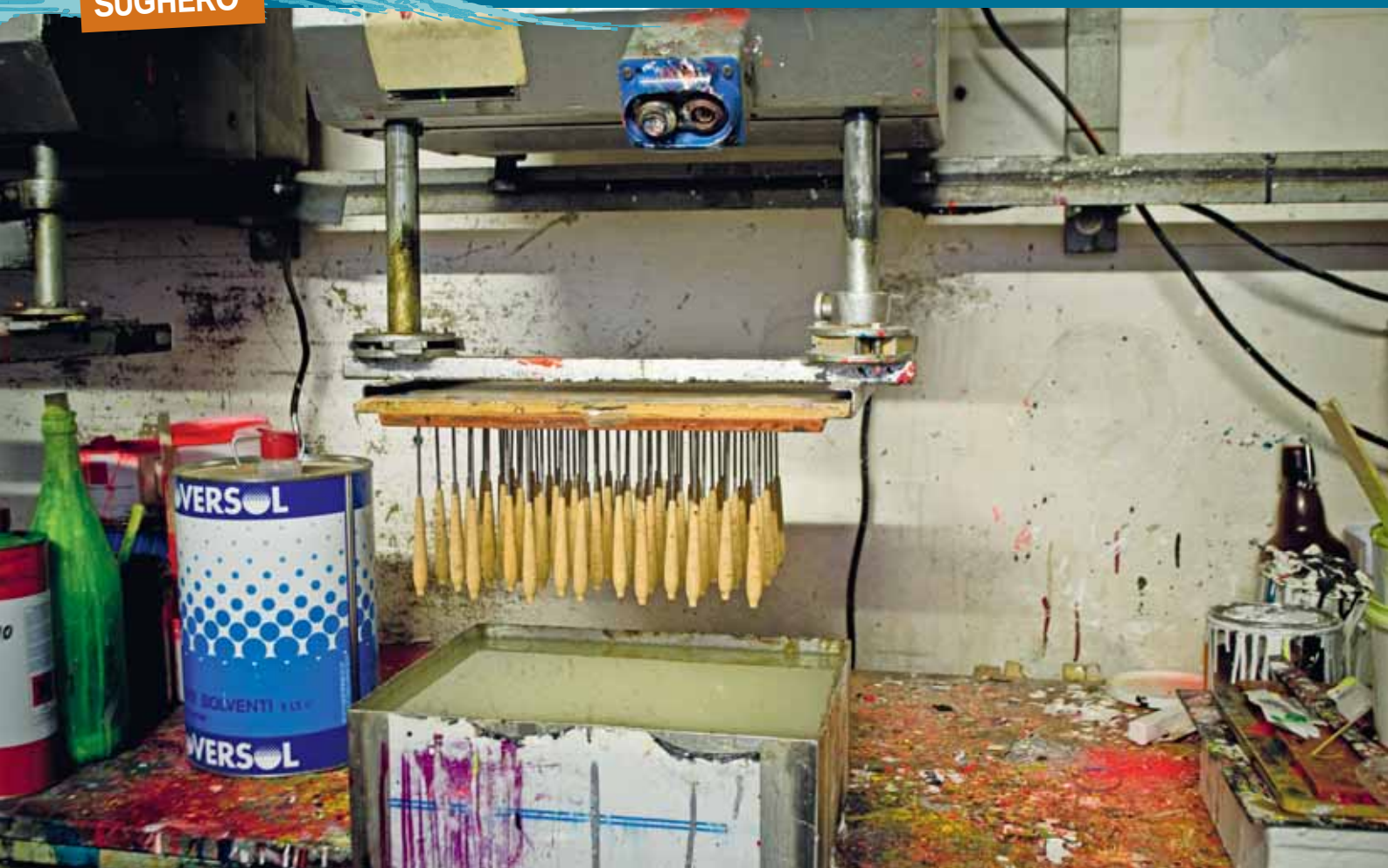
La verniciatura avviene per immersione.
